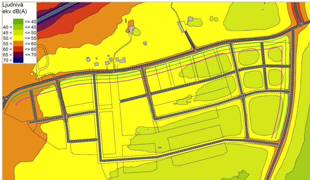
Figur 22. Nollalternativ A. Översikt av buller från väg- och järnvägstrafik inom planområdet. Ljudutbredning för ekvivalent ljudnivå 2 m ovan mark.
