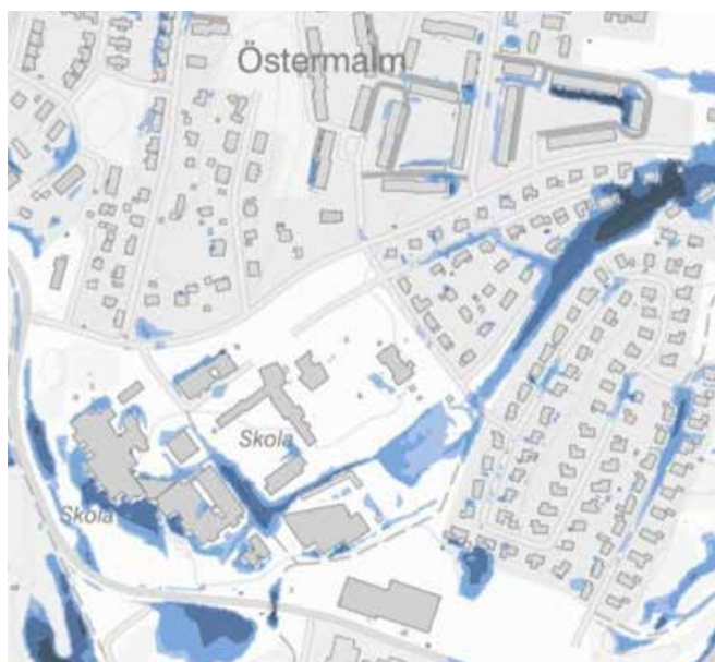
Bild från skyfallskarteringen över delar av Östermalm i Skövde centralort.
