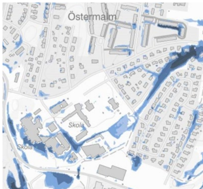
Bild från skyfallskarteringen över delar av Östermalm i Skövde centralort.
