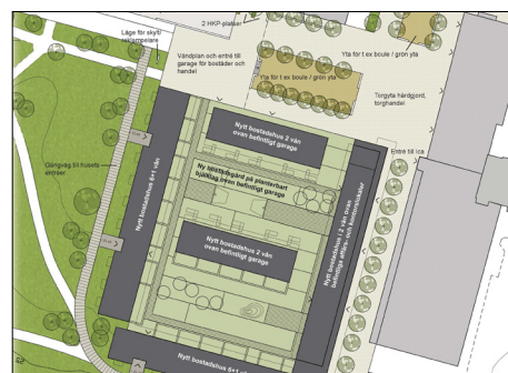
P-hus som byggs runt och på med flerbostadshus, Larsbergs Centrum Lidingö Planillustration Andersson & Jönsson Landskapsarkitekter
