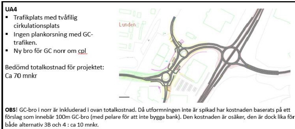
Figur 2, skiss med principiell utformning över valt alternativ för trafikplats Stallsiken. Observera att en ny kostnadskalkyl tagits fram, se vidare §6.
