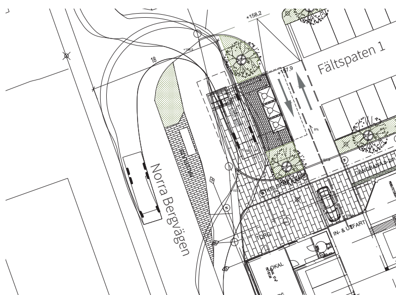
Placering av underjordsbehållare och angöring för att hämta avfall. Förslag och illustration av QPG arkitektur.
