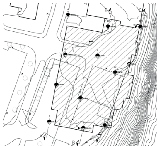
Mätpunkter gjorda inför kommande tillbyggnad
