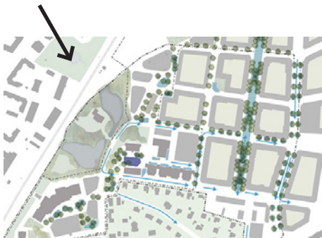
Strömningsriktningarna för dagvatten/skyfall genom Mariesjöes västra delar samt ytor för dagvatten-/skyfallshantering. Bild från gestaltungsprogrammet
