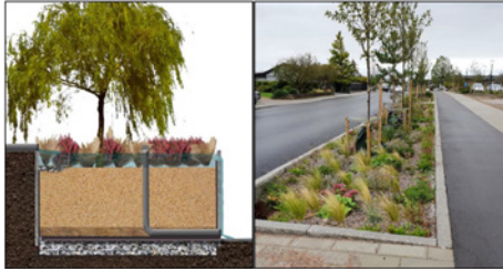
Exempel på trädgropar/regnrabatter från dagvattenutredningen.
