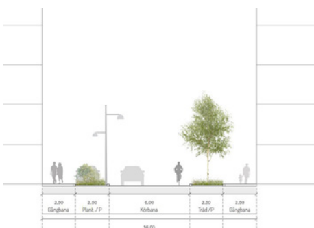
Sektion genom Kaplansgatan med trädplantering på norra sidan och lägre grönzon på södra sidan som separerar gångtrafik från fordons- och cykeltrafik. Bild från Gestaltningsprogrammet för Skövde Science City
