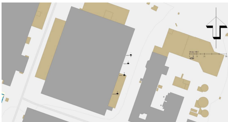
Figur 3 Ritningen visar redovisning av de fyra utförda borrhoparna (Karlstad geokonsult Bilaga C)
