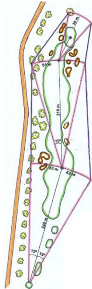
Skiss på säkerhetsavstånd, hämtad ur Rekommendationer vid anläggande och vidareutveckling av golfbanor intill allmän väg (TrV) .
