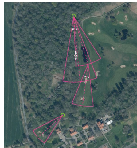
Med utgångspunkt i Trafikverkets skrift kan hål 3 och 4 ha ungefär de här slagvinklarna. Vilket till stor del skärmas av träd och vegetation.
