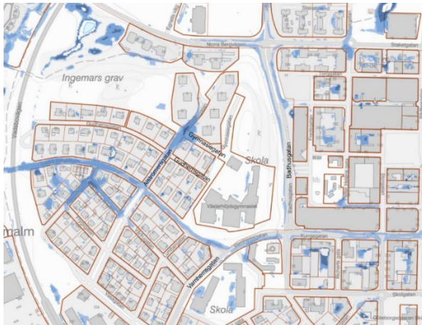
Utsnitt från Skövde kommuns skyfallskartering för tätorten 2023 för ett 100-årsregn. Ju mörkare blå färg desto djupare
