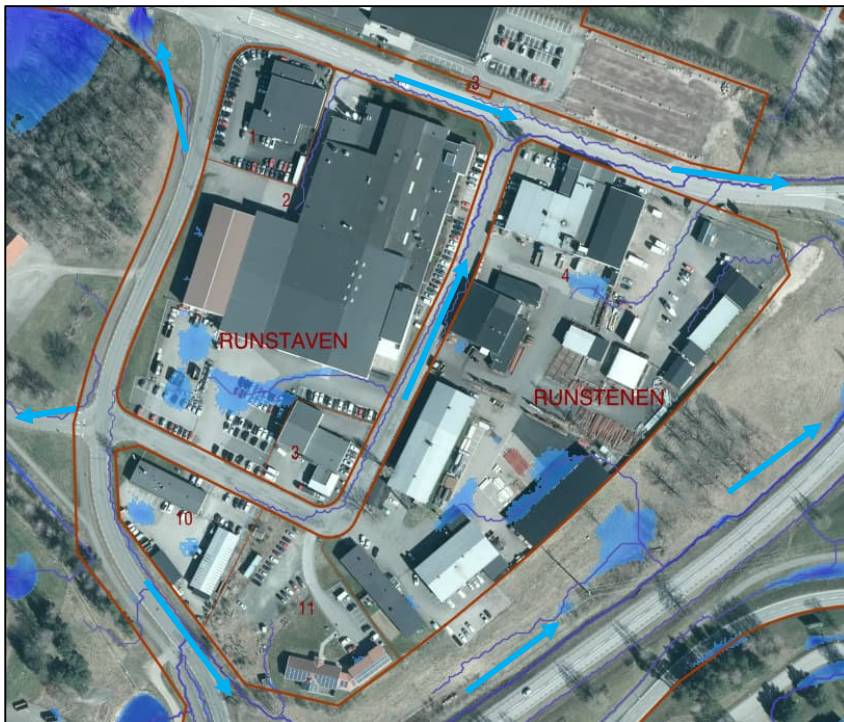
Figur 10. Ytavrinning med illustrerade vattensamlingar (med djup större än 5 cm) inom och i angränsning till planområdet.
