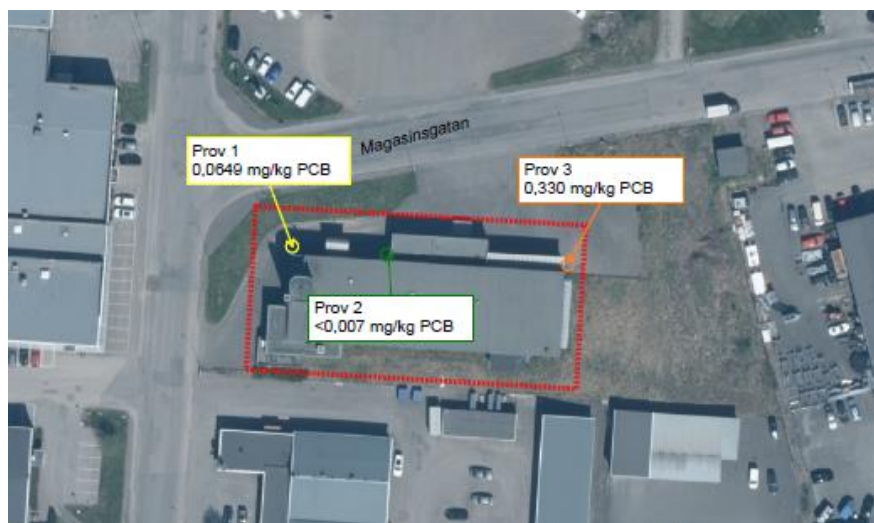
Figur 2. Uttag av jordprover i samband med PCB-sanering på fastigheten Eldaren 1 vintern 2022 (bildkälla: Relement, 2022).
