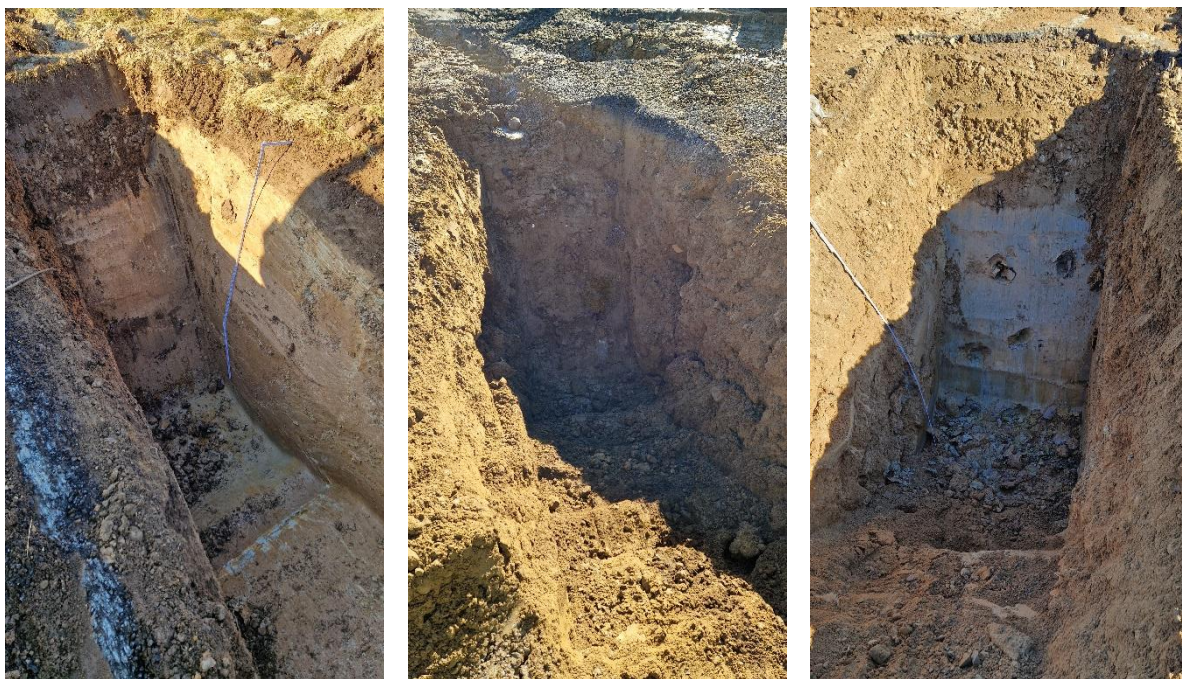
Figur 1. Markprofil i provpunkter 2402 (t.v.), i 2403 (m.) och i 2306 (t.h.) ned till ca 1,7-2,0 m djup
