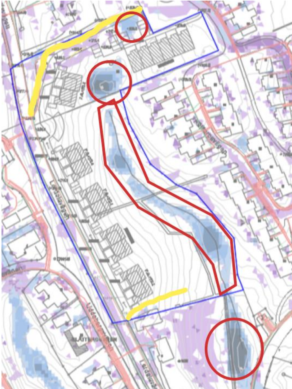
Figur 30. Bilden är ett skärmsklipp på DWG:er i Auto-CAD. Planområdet markeras med blå linje. Skyfallsutredning tillhandahållen av Skövde kommun visar vattendjup (blå fält) och vattenhastighet (lila fält) ju mörkare färg desto djupare respektive högre hastighet.
