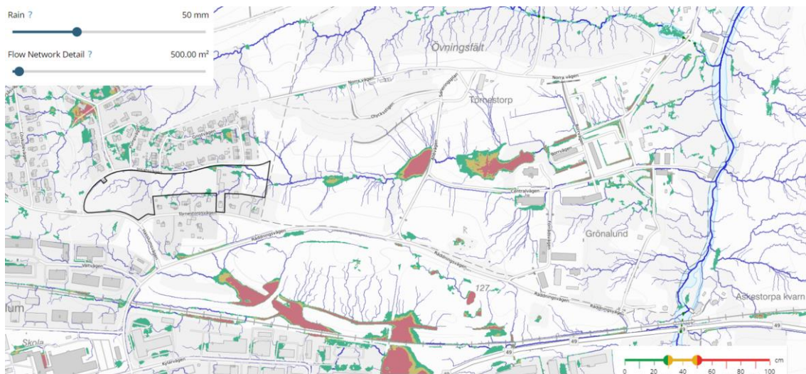
Figur 15. Översvämningskartering i Scalgo för 50 mm regn, planområdet är markerat med svart linje.
