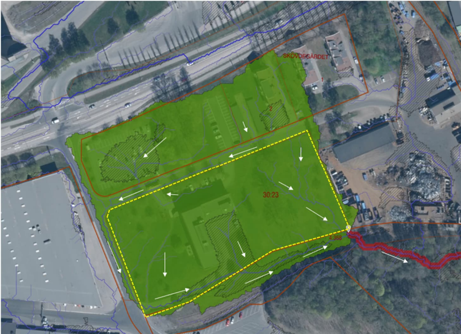
Figur 4 Ytliga flödesvägar samt avrinningsområde. Ytliga flödesvägar redovisas med blåa tunna linjer. Avrinningsriktning har förtillgats med vita pilar. Avrinningsområdet är det gröna området. Befintliga lågpunktsområden är markerade med ett grått raster. Utredningsområdet visas i gulstreckad linje.
