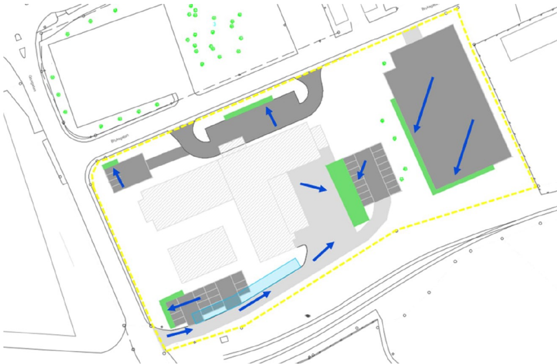
Ytliga avrinningsriktning för avledning till makadamdiken, se blå pilar. Makadamdiken är markerade med gröna områden. Svackdike är markerat med ljusblått område.
