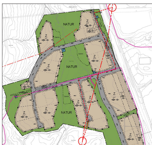
Vattenfalls 22 kV luftledning (punkt-streckad röd) som föreslås markförläggas genom etapp 3 i områdets lokalgator (streckad röd). Vattenfalls 11kV-ledning i vägen till Lunnahult (lila heldragen) kan behöva omförläggas. Skanovas luftledning (tunn punkt-streckad röd) har tagits ur bruk och ska demonteras.
