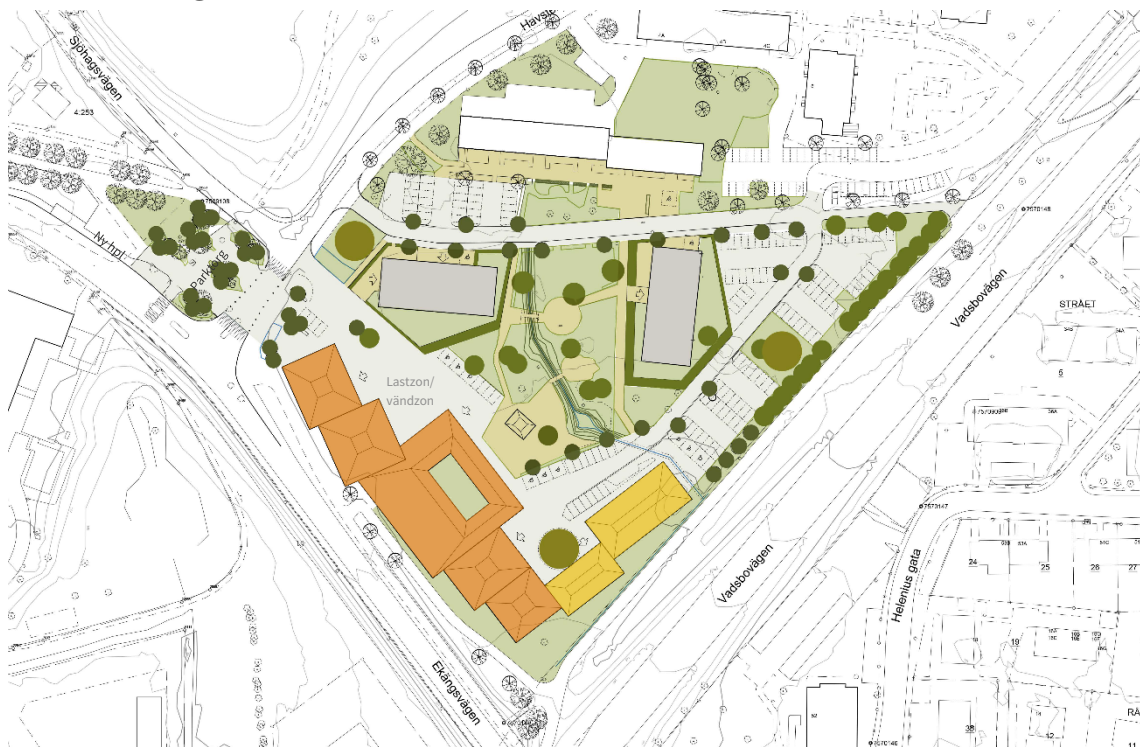
Figur 1. Illustrationsplan över tänkt exploatering. Tilltänkta lokaler för daglig verksamhet är färgade med orange och tilltänkta kontorslokaler är färgade med gult.
