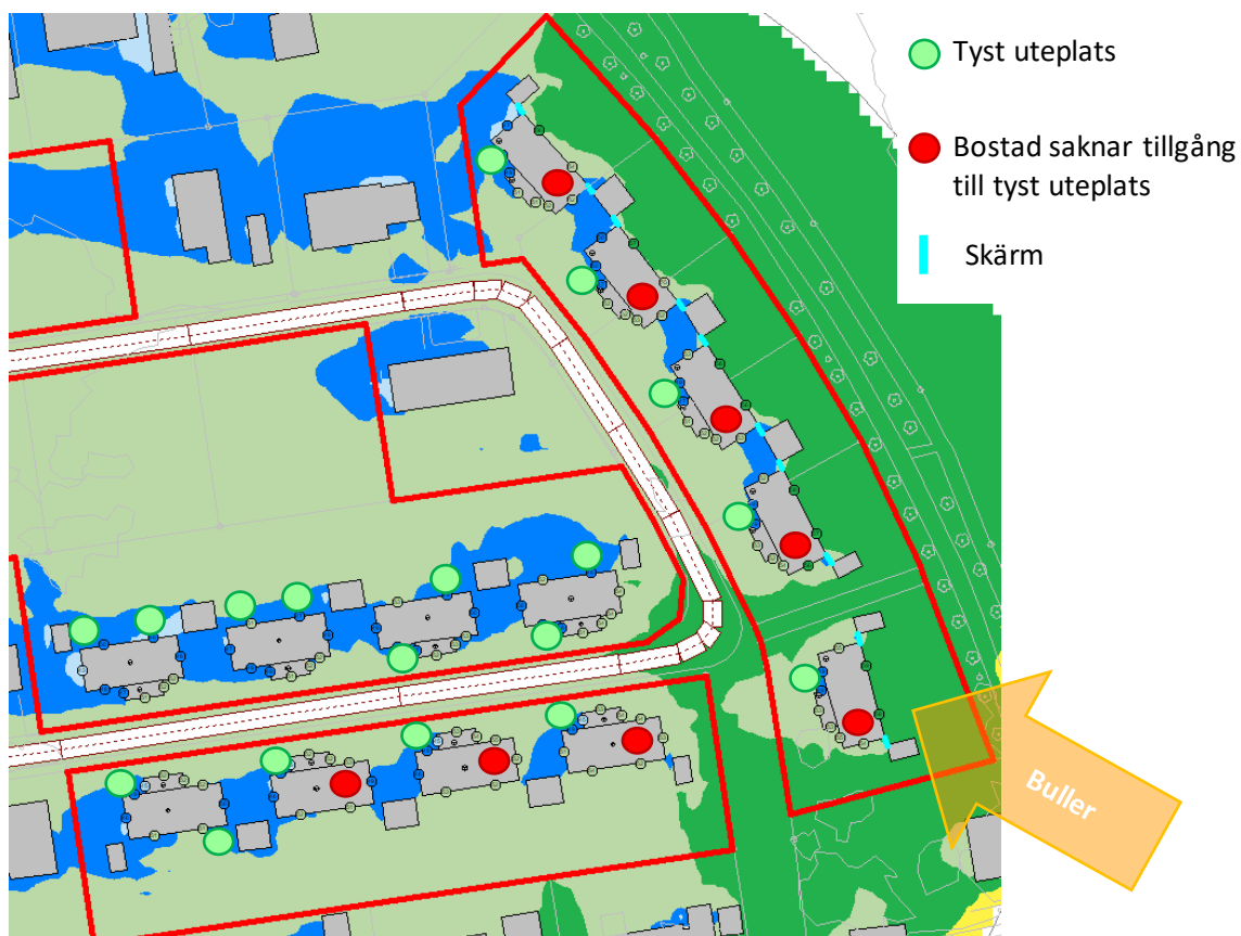
Figur 3 Lagen för tysta uteplatser, samt bostäder där tyst uteplats saknas. Nuvarande exploateringsförslag.
