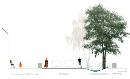
Sektionsskiss för Insatsvägen, befintlig bebyggelse samt dagvattendike.
