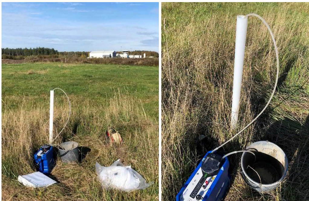
Figur 8. Grundvattenrör i punkt GW1901 som tidigare installerats utav Sweco. Terminalbyggnaderna är synliga i den vänstra bildens högra hörn. Renspumpning 2021-10-08.
