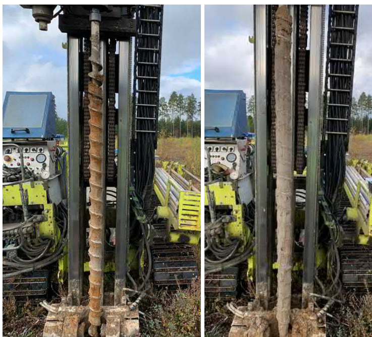
Figur 20. Jordprovtagning i punkt 21TY037M. Till vänster: 0-2 m u my. Till höger: 2-4 m u my. 2021-10-06.
