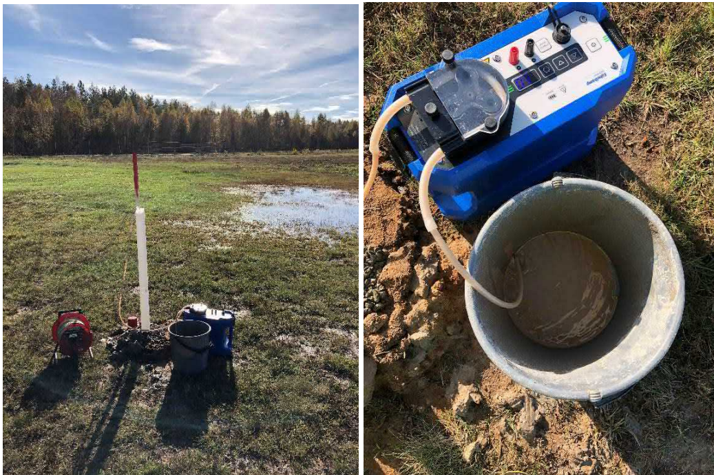
Figur 5. Grundvattenrör i punkt 21TY020. Renspumpning 2021-10-08. Väldigt lerigt vatten pumpas upp.
