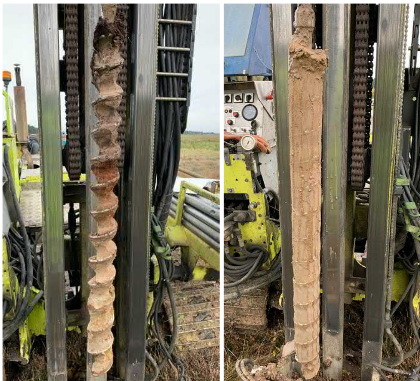
Figur 13. Jordprovtagning i punkt 21TY026M. Till vänster: 0-1 m u my. Till höger: 1-2 m u my. 2021-10-07.
