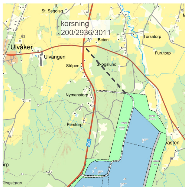
Väganslutning som studerats inför granskningen av detaljplanen.
