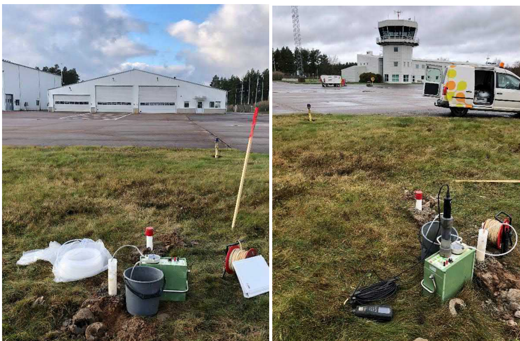
Figur 16. Grundvattenrör i punkt 21TY063 öster om terminalbyggnader. Till vänster: Renspumpning 2021-11-04. Till höger: Provtagning 2021-11-10.
