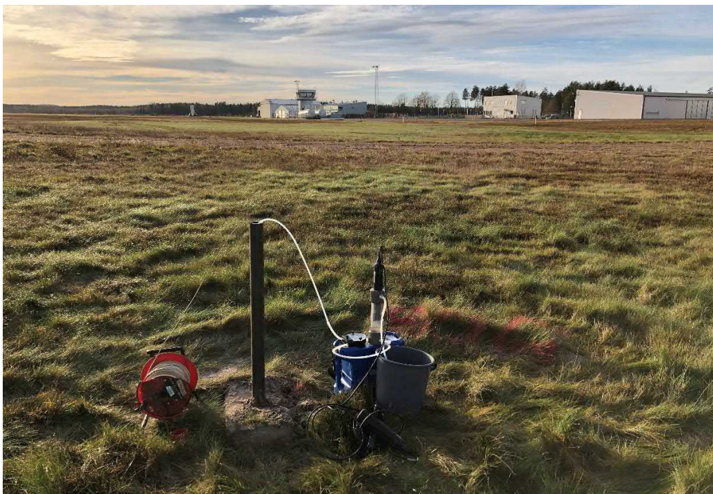
Figur 19. Djupt grundvattenrör i punkt 21TY080. Provtagning 2021-11-23.
