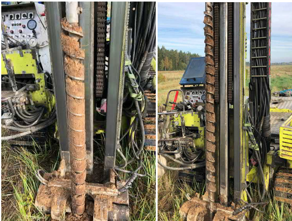
Figur 4. Jordprovtagning i punkt 21TY010M. Till vänster: 0-1 m u my. Till höger: 1-2 m u my. 2021-10-05.
