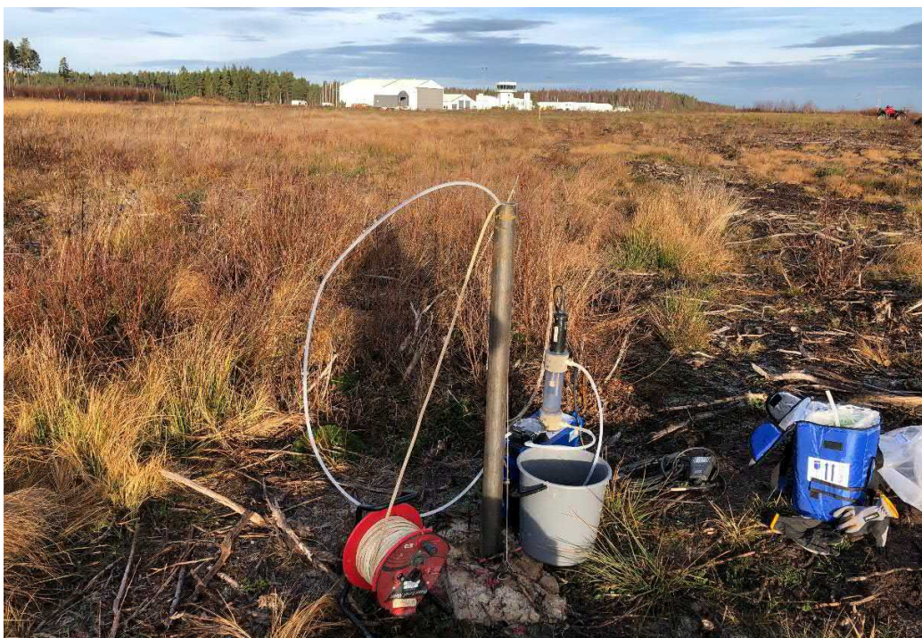
Figur 20. Djupt grundvattenrör i punkt 21TY082. Provtagning 2021-11-23.
