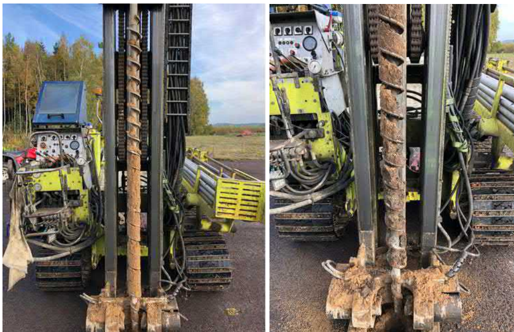
Figur 27. Jordprovtagning i punkt 21TY050M. Till vänster: 0-2 m u my. Till höger: 2-3 m u my. 2021-10-05.
